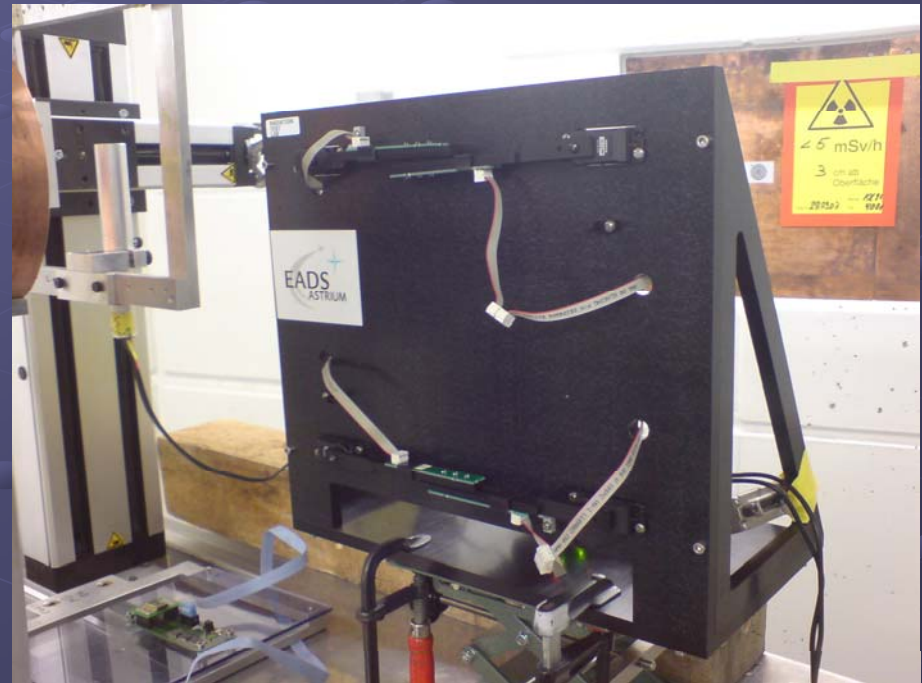
Optocouplers (displacement effects)
